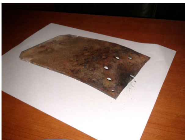
Foto 1 Deformerat rostret & förbränningskammare
